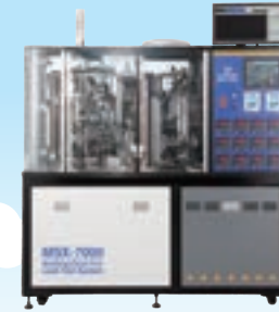
小型電子部品専用 気密検査装置 ⇒小型電子部品のリークテスト装置 (検査対象サイズ:1.0×0.8~1.2×1.0mm)
