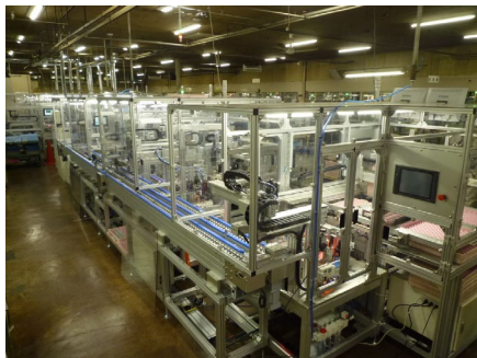
小形圧力計 新自動生産ライン（FA業界向け） 稼働開始（上田計測機器工場） 23万個／月産
