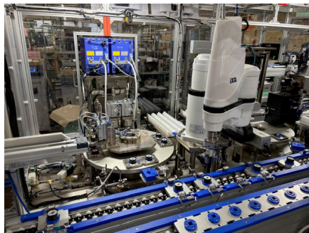
小形圧力計 新自動生産ライン（FA業界向け） 稼働開始（上田計測機器工場） 23万個／月産
